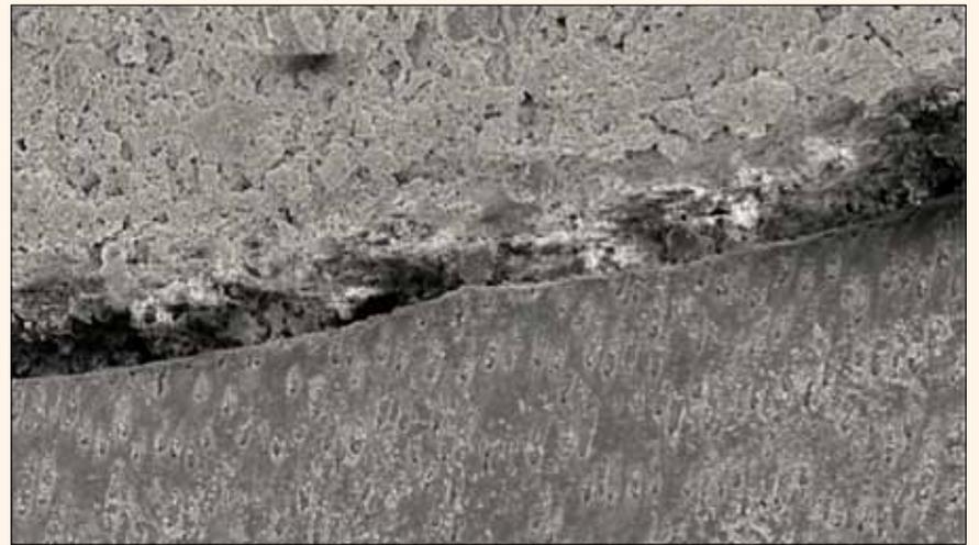
**Figura 1:** Interfaz de desadaptación a dentina de un cemento de hidróxido de calcio fraguado, producida por su contracción de solidificado. Obsérvese el hiatos material-dentina y la falta de sellado de los túbulos dentinarios. FEG SEM x1.250
